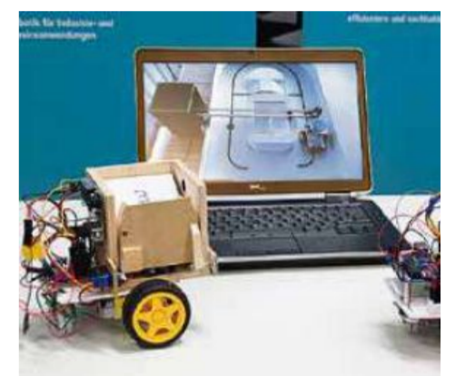
Im Studiengang Wirtschaftsingenieurwesen Technologie und Nachhaltigkeit entwickeln die Studierenden autonome Fahrroboter, die eine energie- und ressourceneffiziente Logistik sortierter Wertstoffe ermöglichen.
