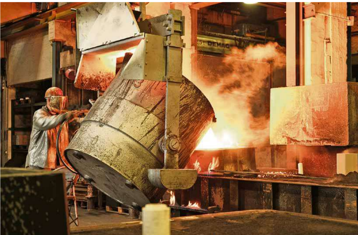
Mit Elektroöfen wird in der Kemptener Eisengießerei das Roheisen geschmolzen.
