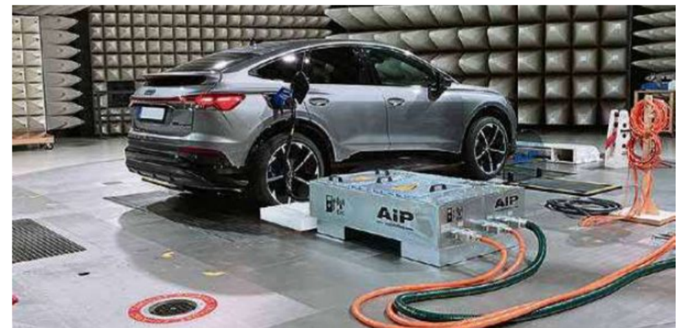
An diesem EMV-Prüfstand mit integrierter Ladetechnik kann eine Straßenfahrt simuliert werden. Zahlreiche renommierte Autohersteller zählen auf diese zukunftsorientierte Technik.
